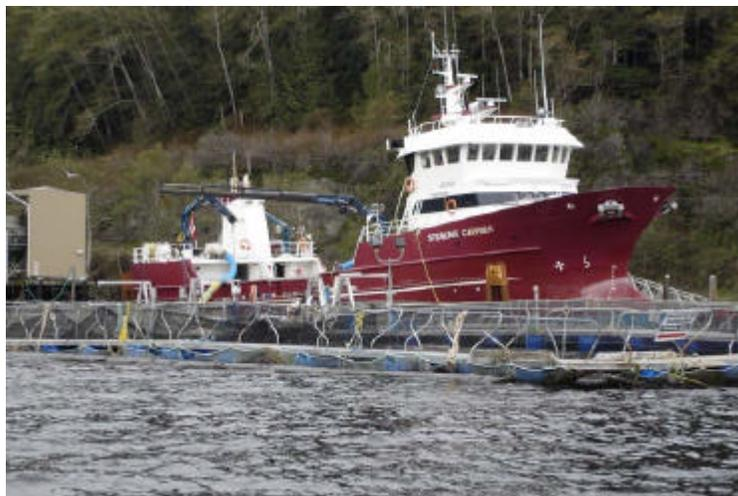
**Figura 23. “Well-Boat” usado na despesca dos peixes**
